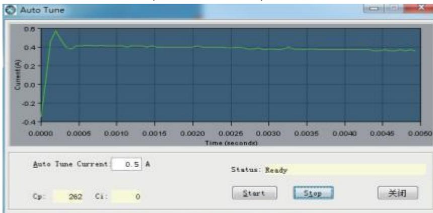
用一个频率扫描测出小的信号，测量电流环的带宽。
