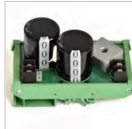
电力网供给用户的交流电，而各种无线装置需要用直流电。整流，就是把交流电变为直流电的过程。利用具有单向导电特性的器件，可以把方向和大小改变的交流电转换为直流电。
